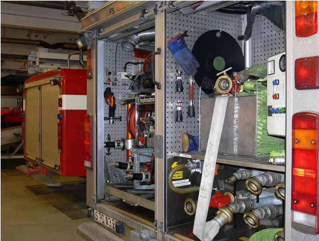
Фото 12 г.Лулео: спецтехника спасательных служб (автомобиль оснащен всем необходимым для тушения пожара и разрезания металла).
