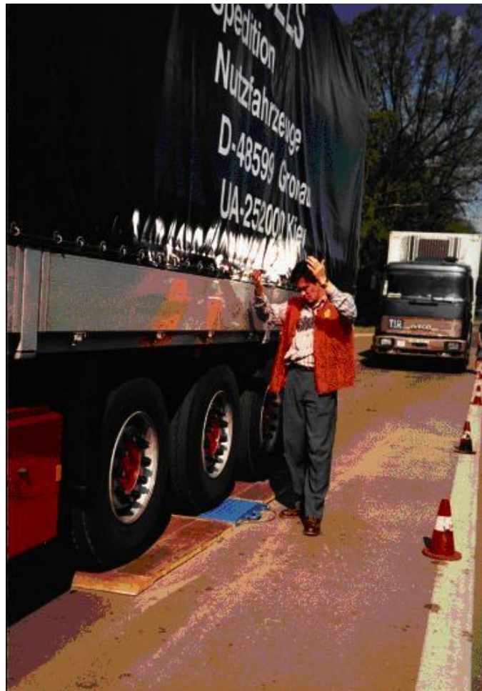
Автомобиль с сочлененной рамой стоит так, чтобы колесо было в центре платформ.
