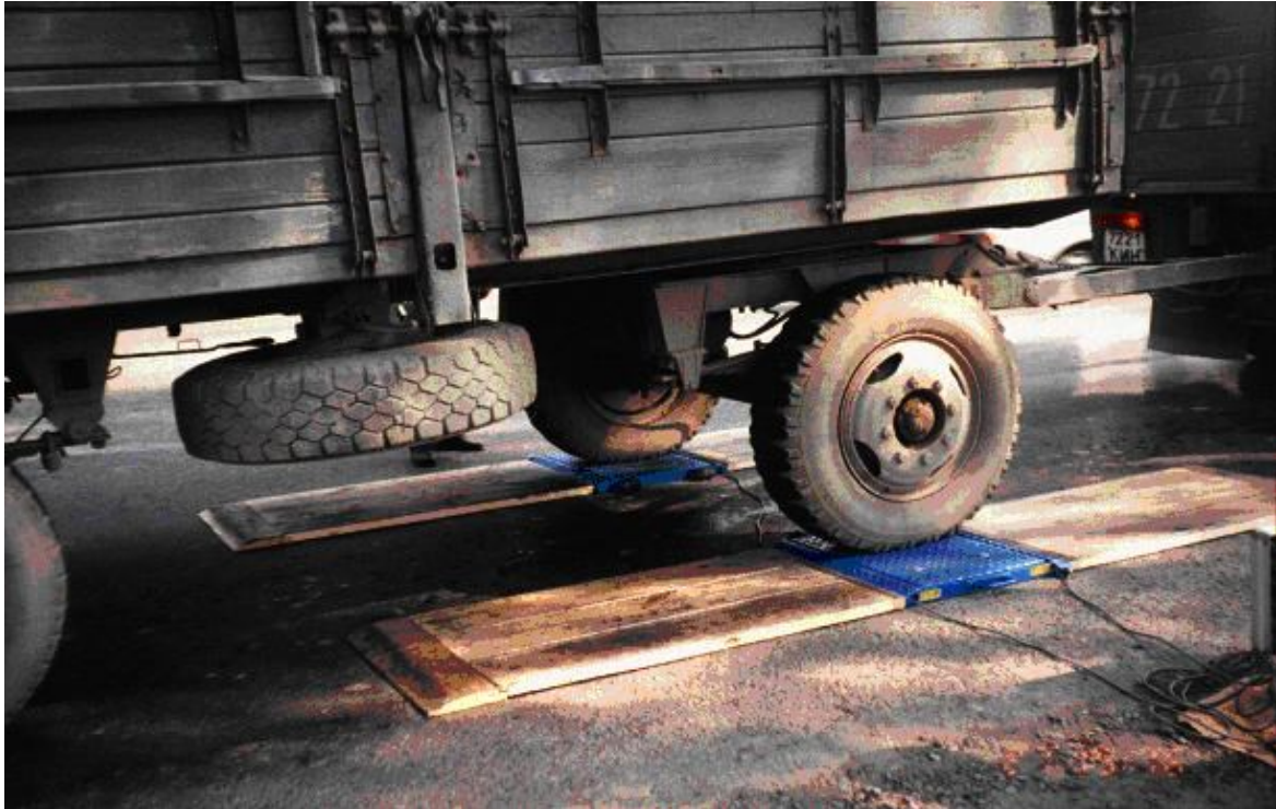
Ось тягача, расположенная по центру платформ.
