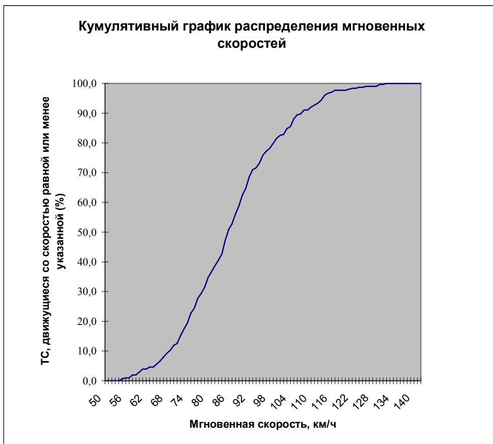
Рисунок 2 – Кумулятивный график распределения мгновенных скоростей, показывающий результаты замеров скоростей движения ТС
