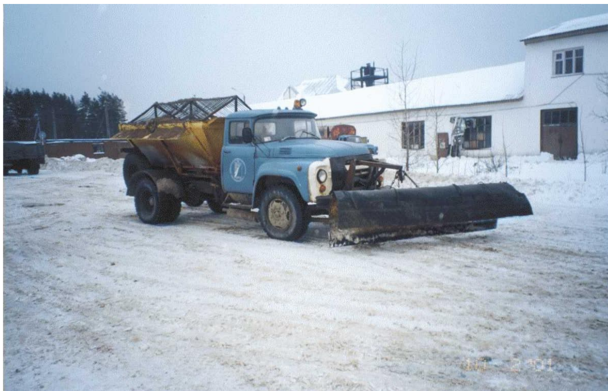
Рисунок 4: Грузовой автомобиль ЗИЛ –130 предназначен для производства множества работ по дорожному содержанию, но может использоваться и для решения сопутствующих задач по содержанию.
