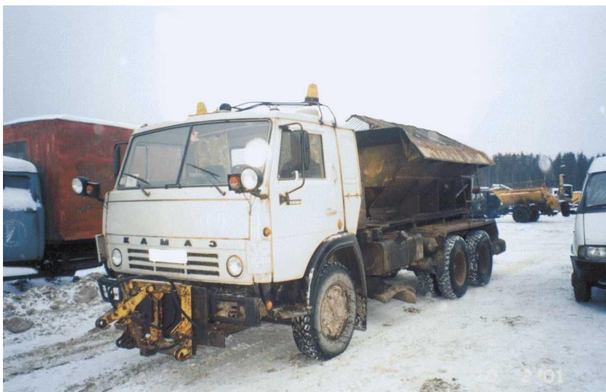
Рисунок 3: Грузовой автомобиль КАМАЗ имеет двигатель 180-240 л.с., что недостаточно для одновременного выполнения нескольких операций.
