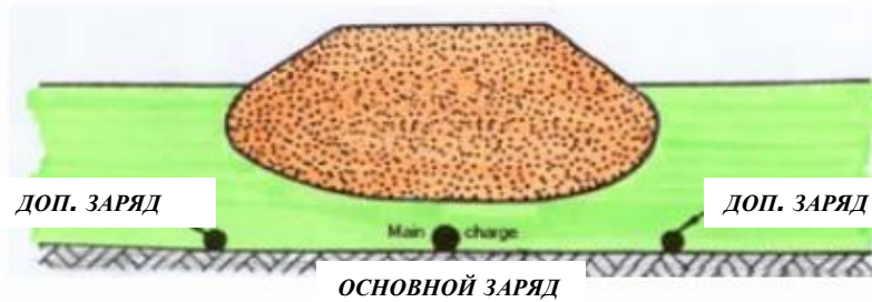
СТАДИЯ 1: ЗЕМЛЯНЫЕ РАБОТЫ ПО УКЛАДКЕ ЗАРЯДОВ
