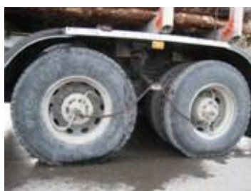
Рисунок 2 Влияние уровня давления воздуха в шинах на величину площади распределения нагрузки
