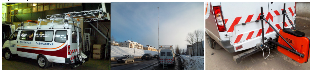
Фото. Общий вид ПДЛ «ТРАССА», работа видеодетектора транспортного потока, установка рупорного антенного блока АБ-1000Р на ПДЛ «ТРАССА»
