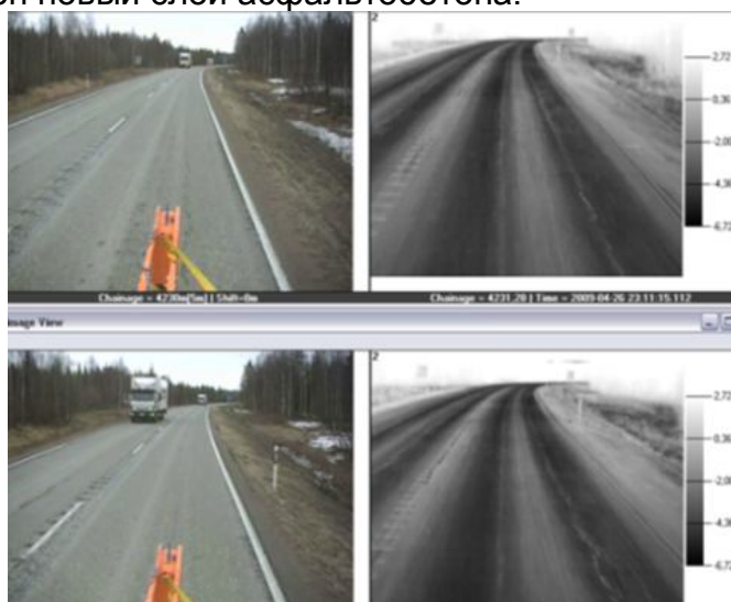
Рисунок 5. Цифровые фотографии и изображения с термальной камеры на участке 505 а/д HW 4, весна 2009г. Данные термальной камеры свидетельствуют о наличии проникающих трещин в покрытии. Более холодные зоны по обеим колеям свидетельствуют о выжимании воды через трещины в покрытии.
