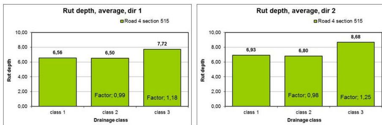
Рисунок 31. Средняя глубина колеи для направления 1 (слева) и 2 (справа) по каждому классу состояния водоотвода.
