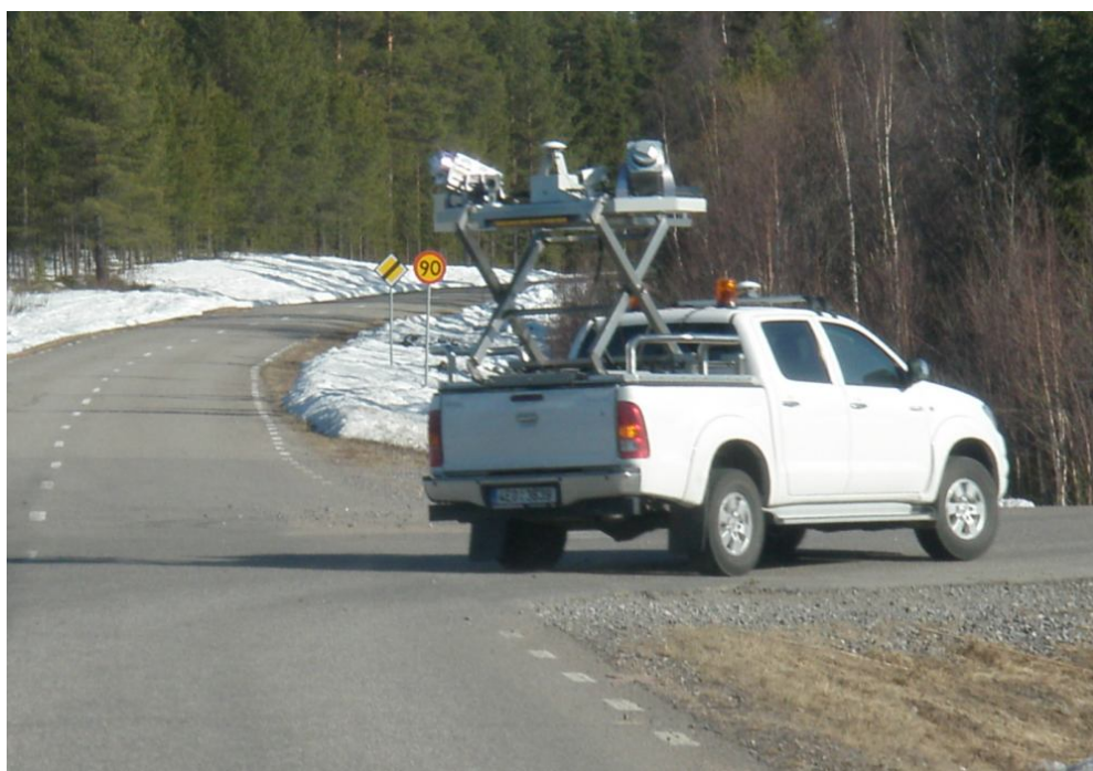
Рисунок 3. Транспортное средство, оснащенное мобильным лазерным сканером GEOVAP Quantum 3D, апрель 2011г.
