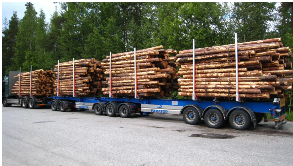
Рисунок 1. Грузовой 90-тонный автопоезд длиной 30,5м на испытаниях в рамках проекта “En Trave Till” (еще один прицеп) в Северной Швеции.
