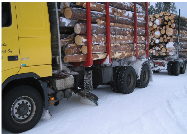
Рисунок 5 Нижний отвал-нож, установленный на лесовозе в Финляндии, которые используются также для зимнего содержания лесных дорог
