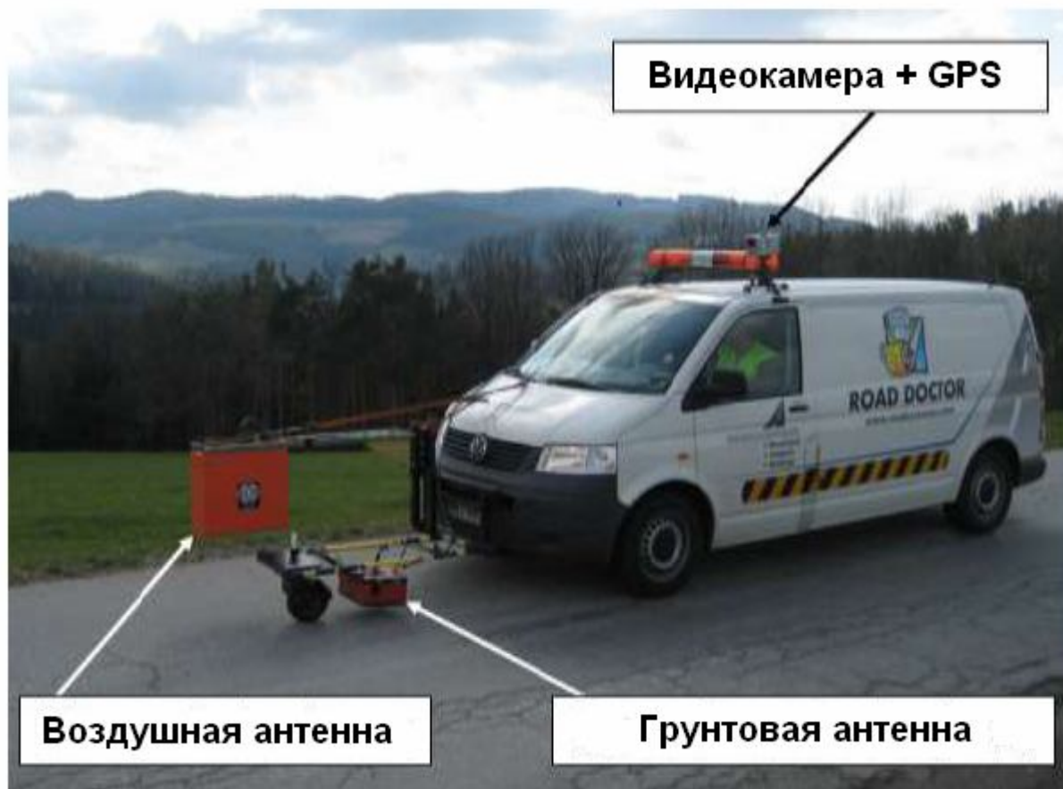
Рисунок 8 Передвижная измерительная станция с антеннами георадара, GPS и видеокамерой
