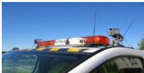
Камеры для обследования водоотвода
