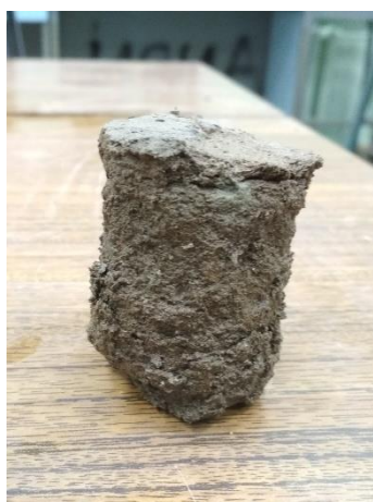
Рисунок 2.9 – Характерные дефекты образцов после 15 циклов промораживания-оттаивания
