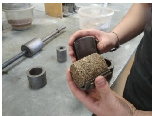
Рисунок 2.2 – Извлечение образца песчаного грунта
