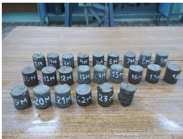
Рисунок 2.8 – Образцы после 15 циклов промораживания-оттаивания
