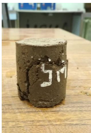
Рисунок 2.9 – Характерные дефекты образцов после 15 циклов промораживания-оттаивания
