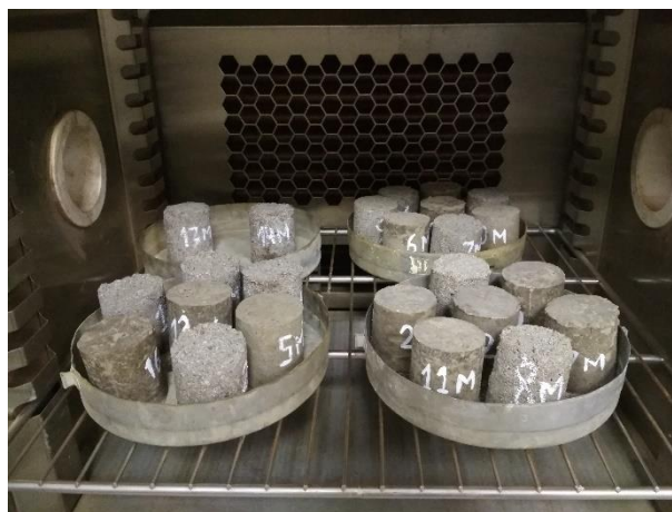
Рисунок 2.7 – Образцы в климатической камере после очередного цикла промораживания
