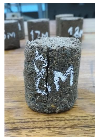
Рисунок 2.9 – Характерные дефекты образцов после 15 циклов промораживания-оттаивания
