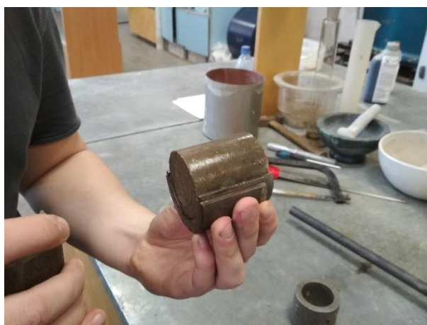
Рисунок 2.3 – Извлечение образца глинистого грунта
