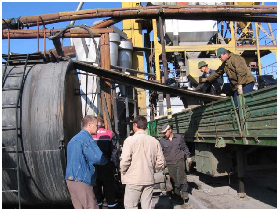
Рис. 1. Загрузка брикетов БИТРЭК в битумный котел
