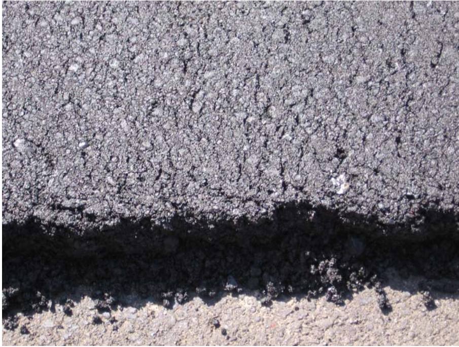
Рис.6. Вид асфальтобетонной смеси приготовленной на основе БИТРЭЖ на а/д. Котлас - Коряжма - Виледь – И. Подомское км 55+800 – 56+400
