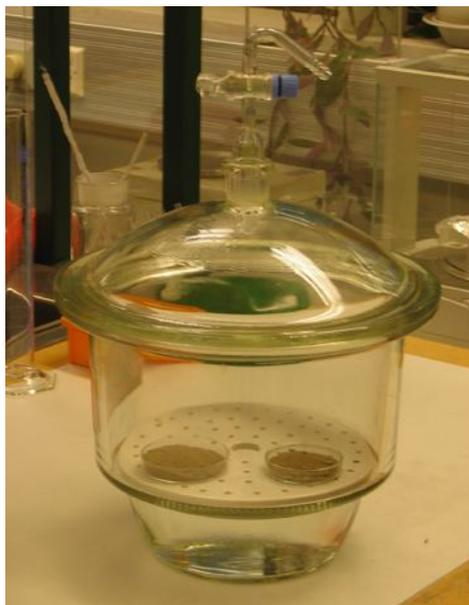
*Рисунок 5: Контейнер с испытываемыми образцами материала при определении коэффициента водопоглощения.*
