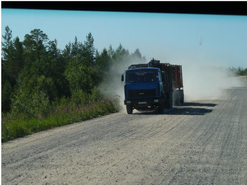
*Рисунок 11. Пылеобразование как одна из типичных проблем пилотной дороги.*
