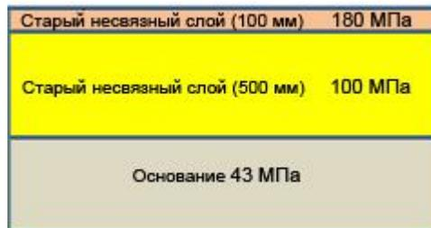
Рисунок 15. Существующая дорожная конструкция и модули упругости слоев дорожной одежды и грунтов земляного полотна на пилотном участке км 47-49
