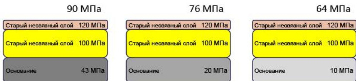
Рисунок 17. Результаты расчета несущей способности существующей дорожной конструкции с использованием метода ROADEX по Одемарку при различных модулях упругости грунтов земляного полотна. В качестве расчетной дорожной конструкции использована наиболее слабая – на участке км47-49.
