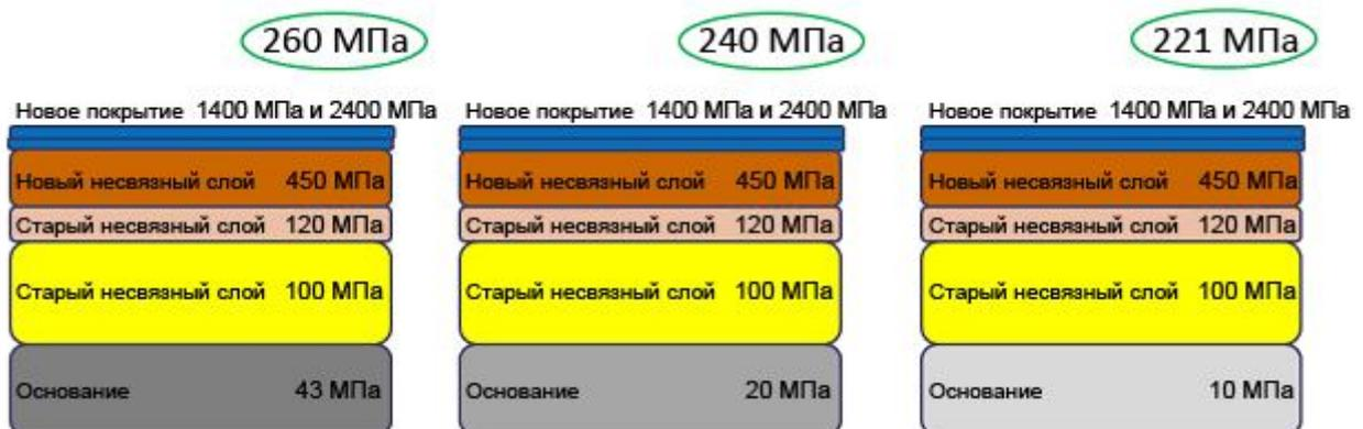
Рисунок 23. Расчетные показатели несущей способности ROADDEX по Одemarkу для варианта восстановления в качестве дороги с твердым покрытием (русская версия) при разных модулях упругости земполотна. Целевой показатель несущей способности – 160МПа.
