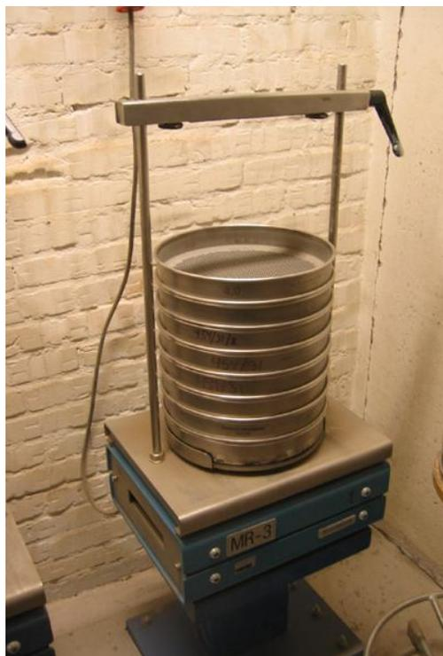
*Рисунок 4: Набор сит для определения гранулометрического состава материала.*
