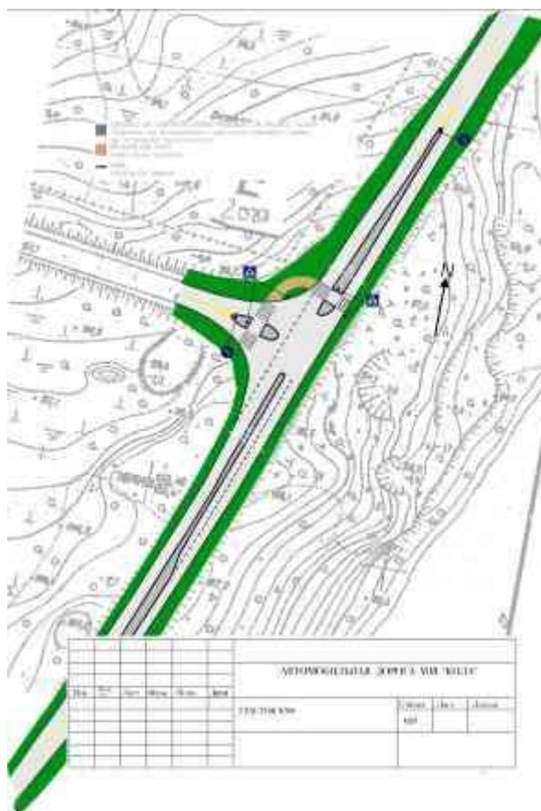
*Мероприятия, предлагаемые для снижения дорожной аварийности на примыкании ул.Планерная, пакет среднетратных мер*
