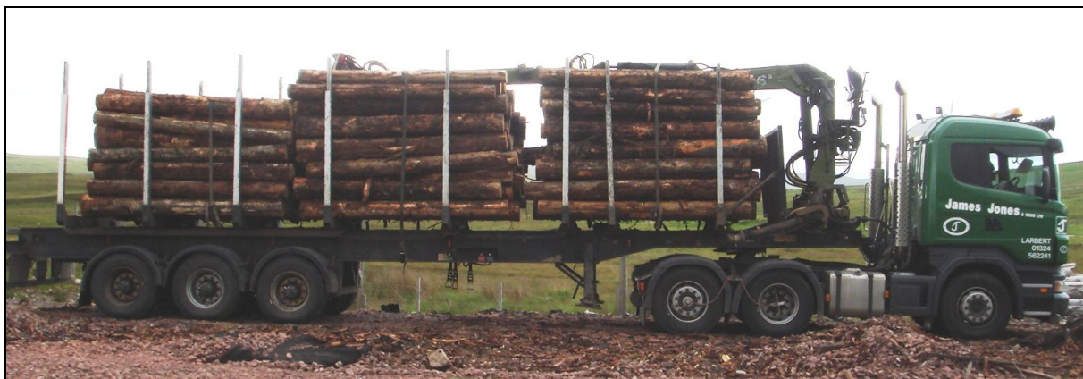
Рисунок 4.2 Фотография груженого лесовоза компании James Jones, оснащенного системой TPCS, тягач 6x2 с неведущим задним поддерживающим мостом и трехосным прицепом при перевозке леса по а/д А897, июль 2007
