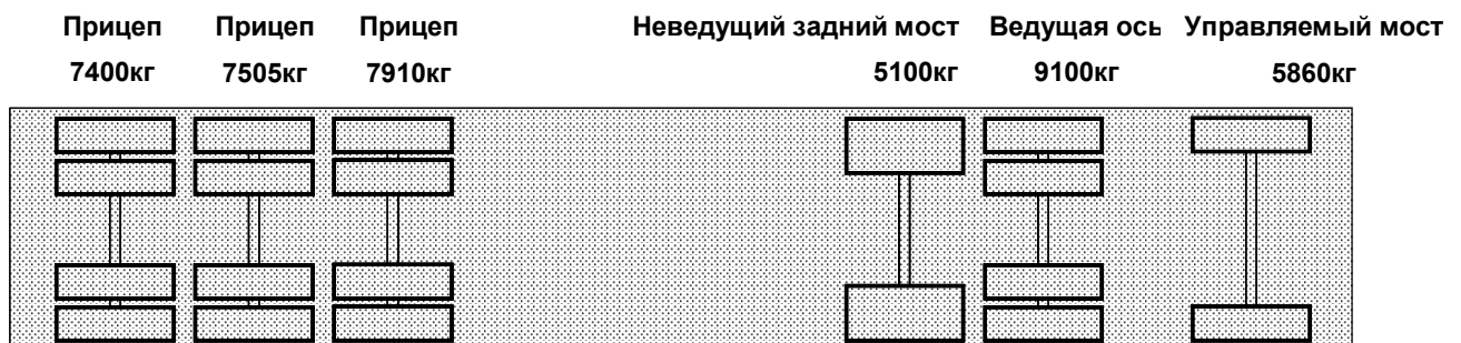
Рисунок 3.2 Схема расположения осей тестируемого транспортного средства с указанием нагрузок по осям в кг
