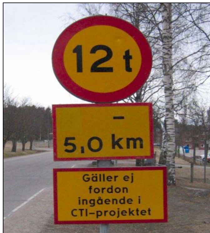
Рисунок С1 Временный дорожный знак на автомобильной дороге S926 в Вярмленде, Швеция На информационной табличке внизу: "Не распространяется на участвующих в проекте централизованной подкачки шин "
