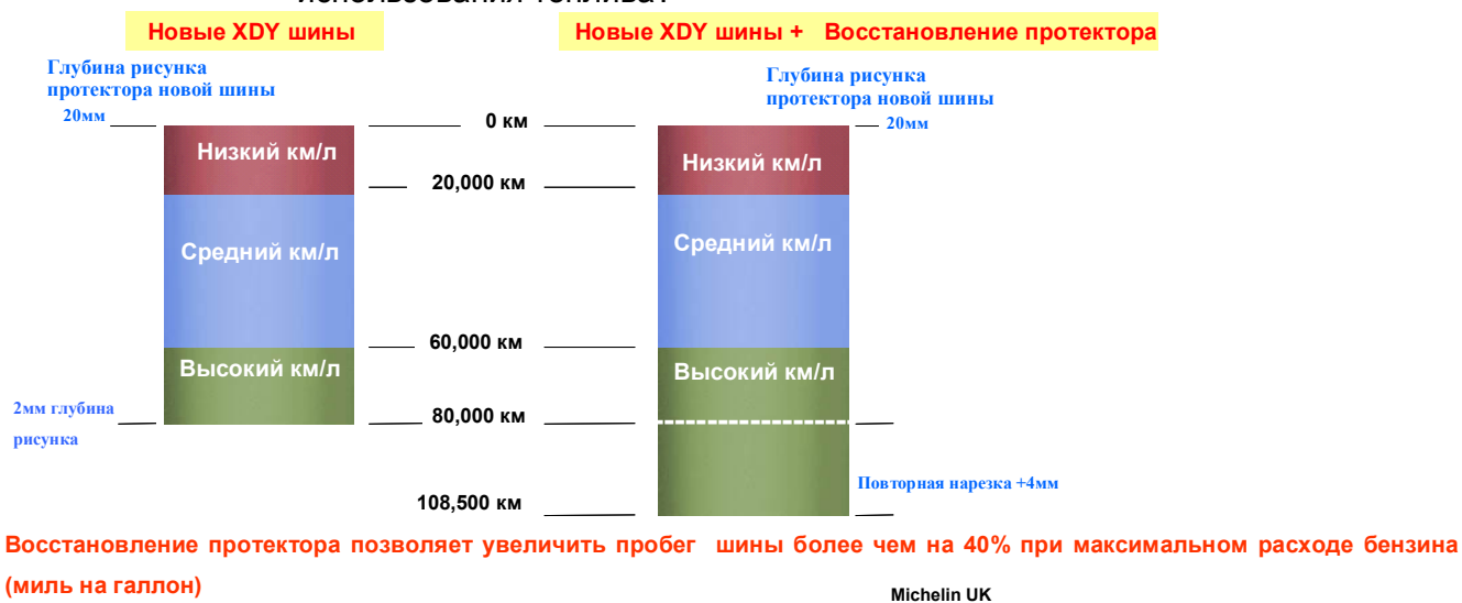
Рисунок 5.1 Диаграмма, показывающая, насколько восстановление протектора шины способно увеличить эффективность использования топлива
