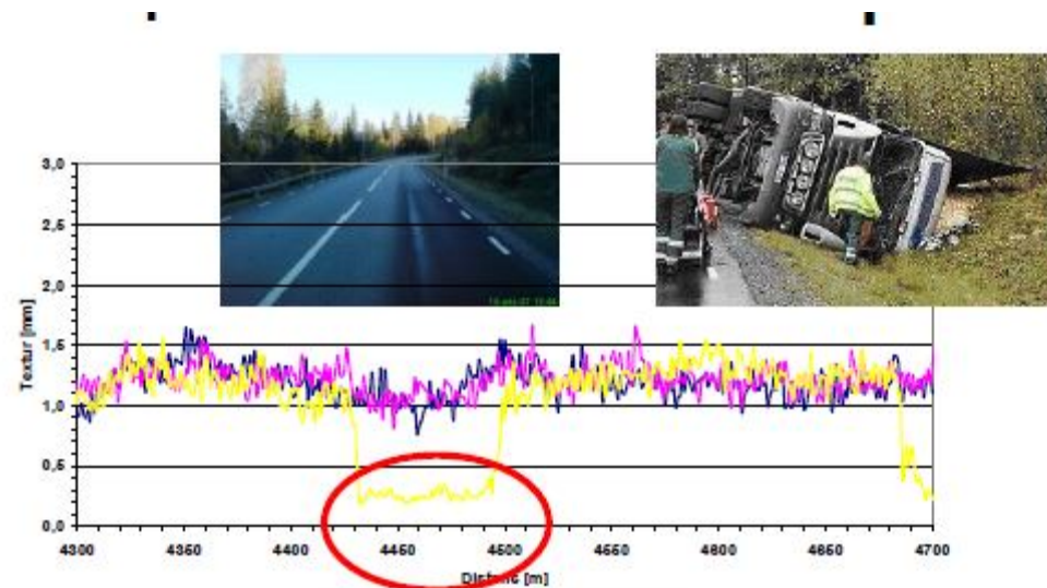
Диаграмма 1 Участок дороги, где следствием ямочного ремонта стало различие коэффициентов сцепления на правой и левой колее
