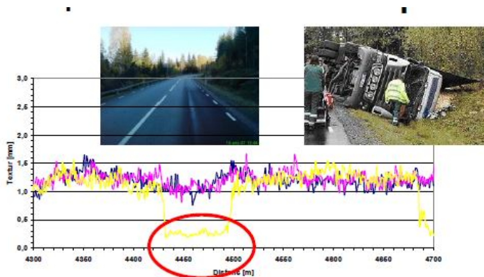
Диаграмма 1 Участок дороги, где следствием ямочного ремонта стало различие коэффициентов сцепления на правой и левой колее
