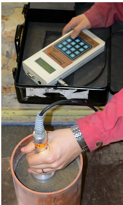
Рисунок 7. Измерения диэлектрического показателя и электропроводимости верхней части образца, помещенного во всасывающую трубку
