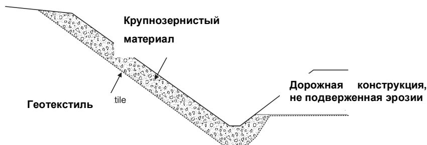
Рисунок 3.6 Защита внешнего откоса канавы
