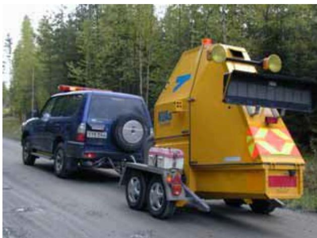
**Рисунок 4.4. Дефлектометр падающего груза KUAB (Аho 2004)**
