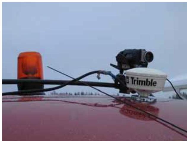
**Рисунок 4.2. Цифровая видеокамера и GPS-приемник, установленные на автомобиле, оснащенном георадарным оборудованием.**
