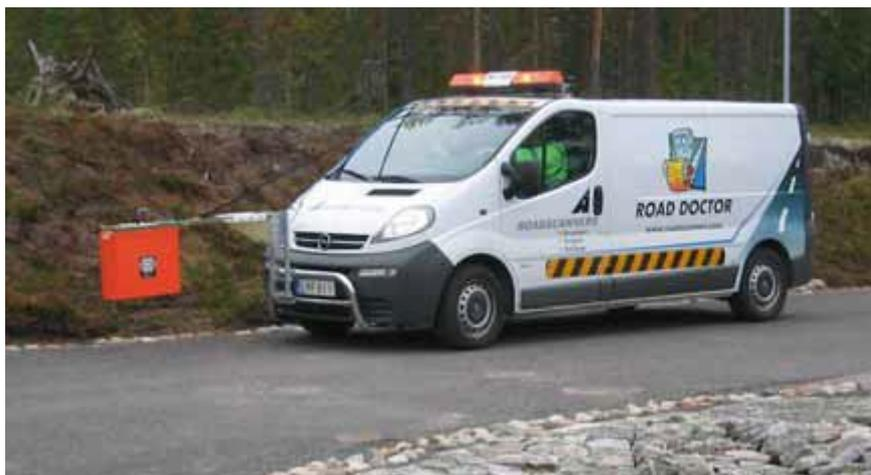
**Рисунок 4.3. Автомобиль, оснащенный георадарным оборудованием (рупорная антенна частотой 1ГГц)**
