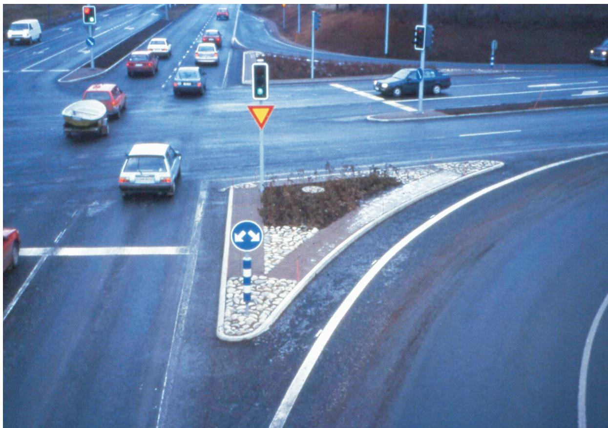
**Фото 2.** Канализирование движения для снижения риска аварийности на пересечении
