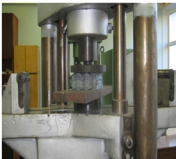
Рис. 19 Изготовление образцов для определения коэффициента теплопроводности
