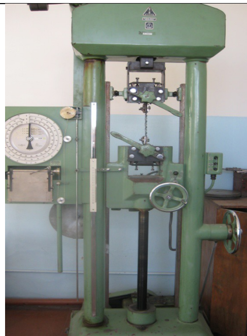
Рис. 14 Растяжение образца после многократного замораживания и оттаивания
