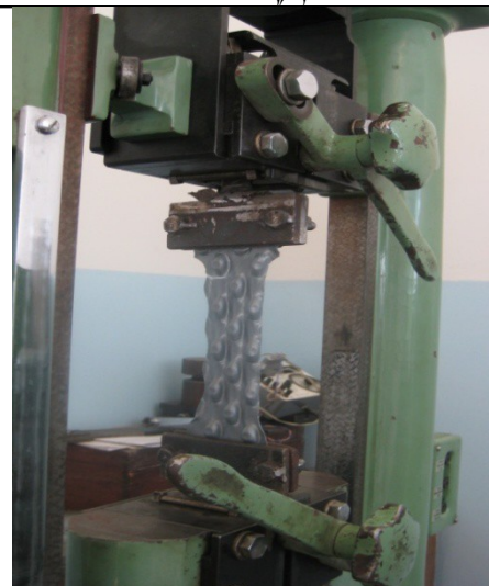
Рис. 4 Заправка пробы в захваты разрывной машины ЦДМ-5
