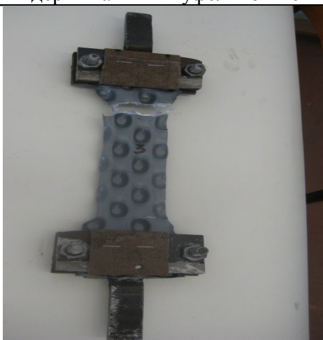
Рис. 15 Растяжение образца после выдерживания в муфельной печи
