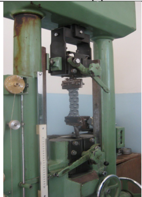
Рис. 4 Заправка пробы в захваты разрывной машины ЦДМ-5
