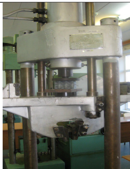
Рис. 22 Уменьшение воздушных прослоек между слоями материала
