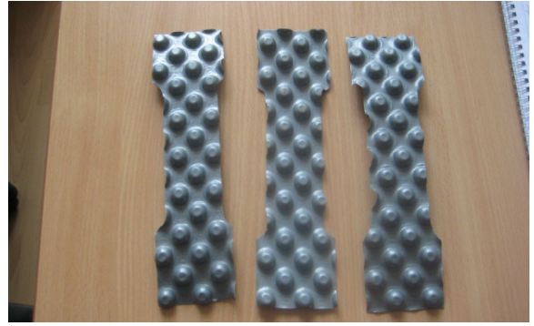
Рис.2 Изготовление образцов гантелевидной формы
