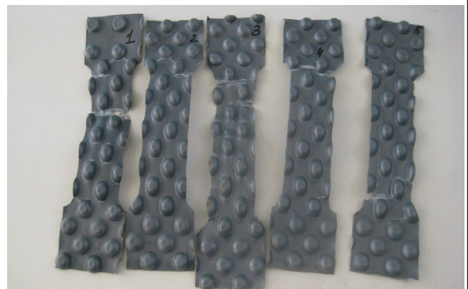
Рис. 16 Растяжение образца после выдерживания в муфельной печи
