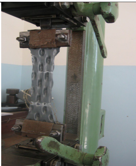
Рис. 15 Растяжение образца после выдерживания в муфельной печи
