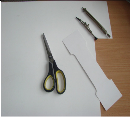
Рис.1 Изготовление шаблонов гантелевидной формы
