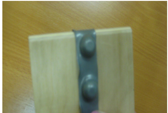
Рис. 28 Изгибание образцом испытательного бруса
