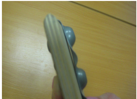
Рис. 26 Испытания на гибкость при отрицательных температурах
