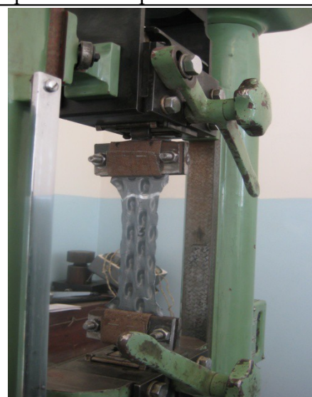
Рис. 16 Растяжение образца после выдерживания в муфельной печи
