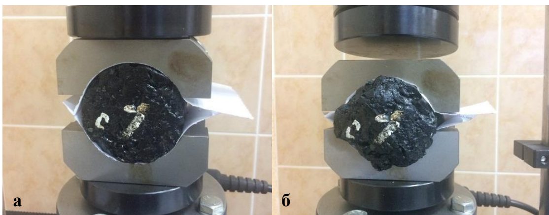
Рисунок 23 – Образец (а) до и (б) после испытания по схеме Маршалла
