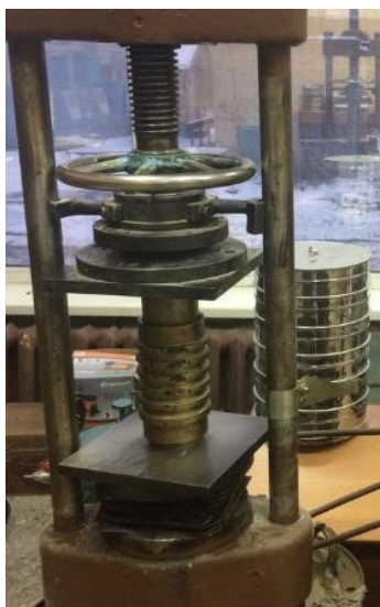
Рисунок 15 – формирование образцов на прессе гидравлическом ПСУ-10
