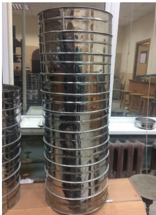
Рисунок 11 – Набор сит для испытания песка и щебня с размерами ячеек 40; 20; 15; 10; 5; 2,5; 1,25; 0,63; 0,315; 0,16; 0,071
