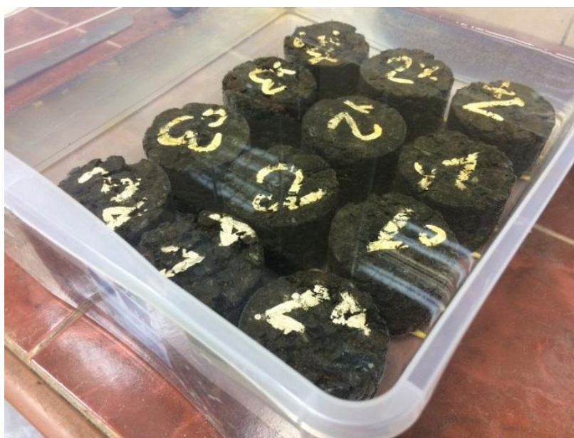
Рисунок 24 – Образцы при определении водостойкости при длительном водонасыщении.
