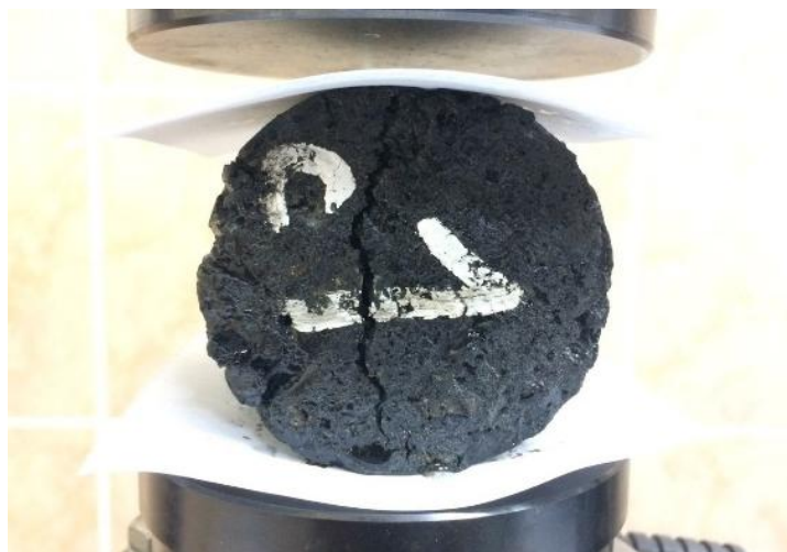
Рисунок 21 – Образец, испытанный на трещиностойкость
